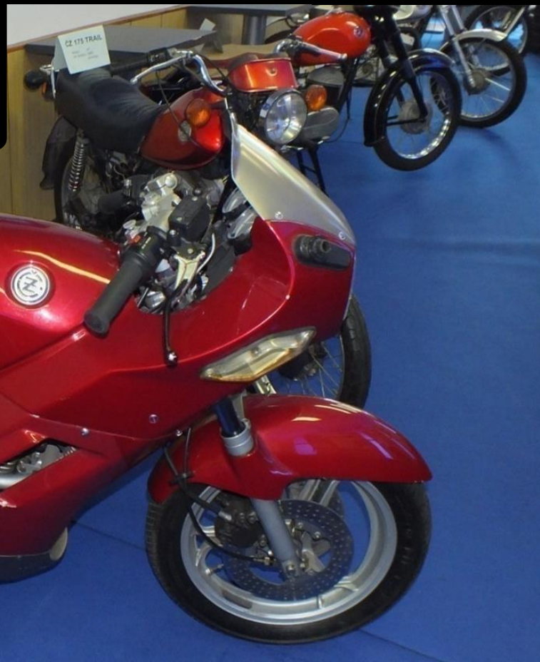
ČZ 400 (1991), prototyp(e) Čtyřtákní dvouválec Four-stroke twin-cylinder
