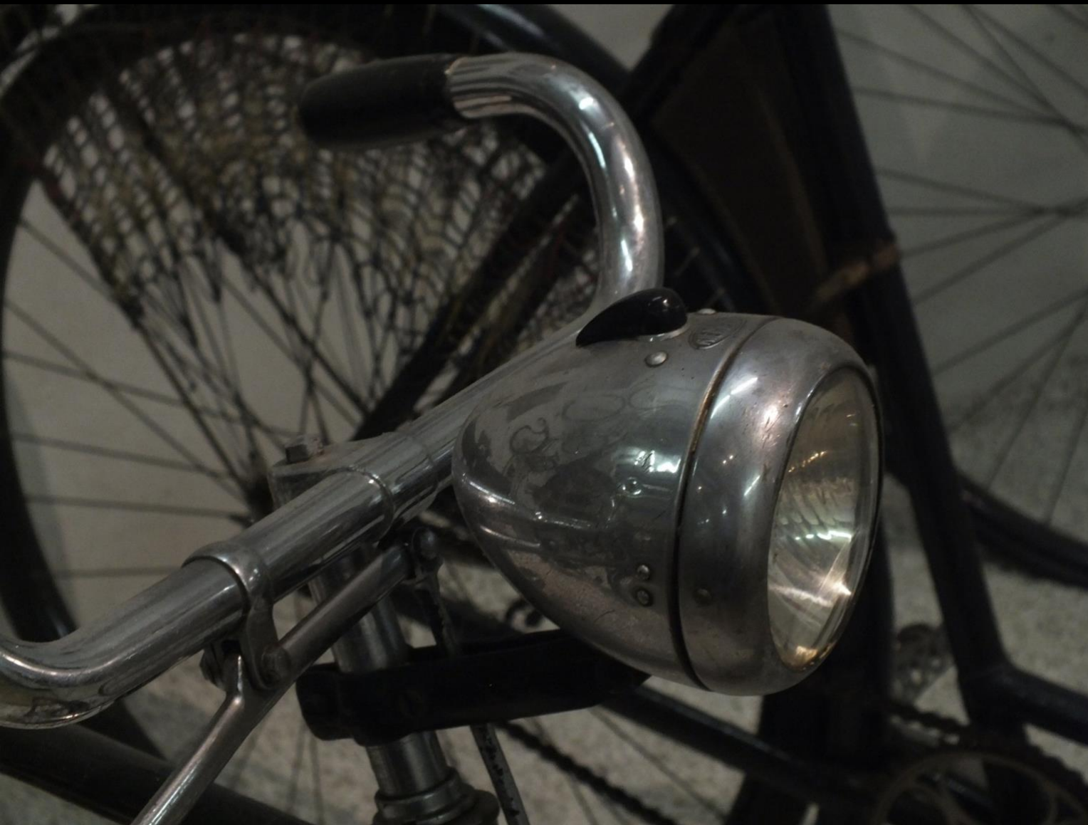
Světlomet se dvěma režimy – potkávací a dálkové světlo Headlight with two modes – meeting and driving beam Światło dwutrybowe – światło mijania oraz drogowe
