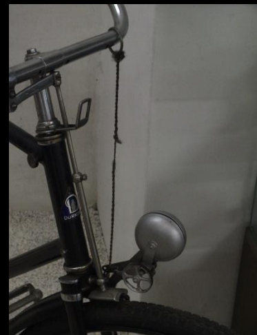
↑ (1918, Dürkopp) Zvonek poháněný kolem Bell driven by wheel Dzwonek napędzany przez koło
